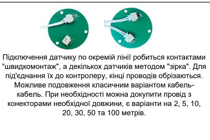
Підключення датчика по окремій лінії робиться контактами "швидкомонтаж", а декількох датчиків методом "зірка". Для під'єднання їх до контролера, кінці проводів обрізаються.
